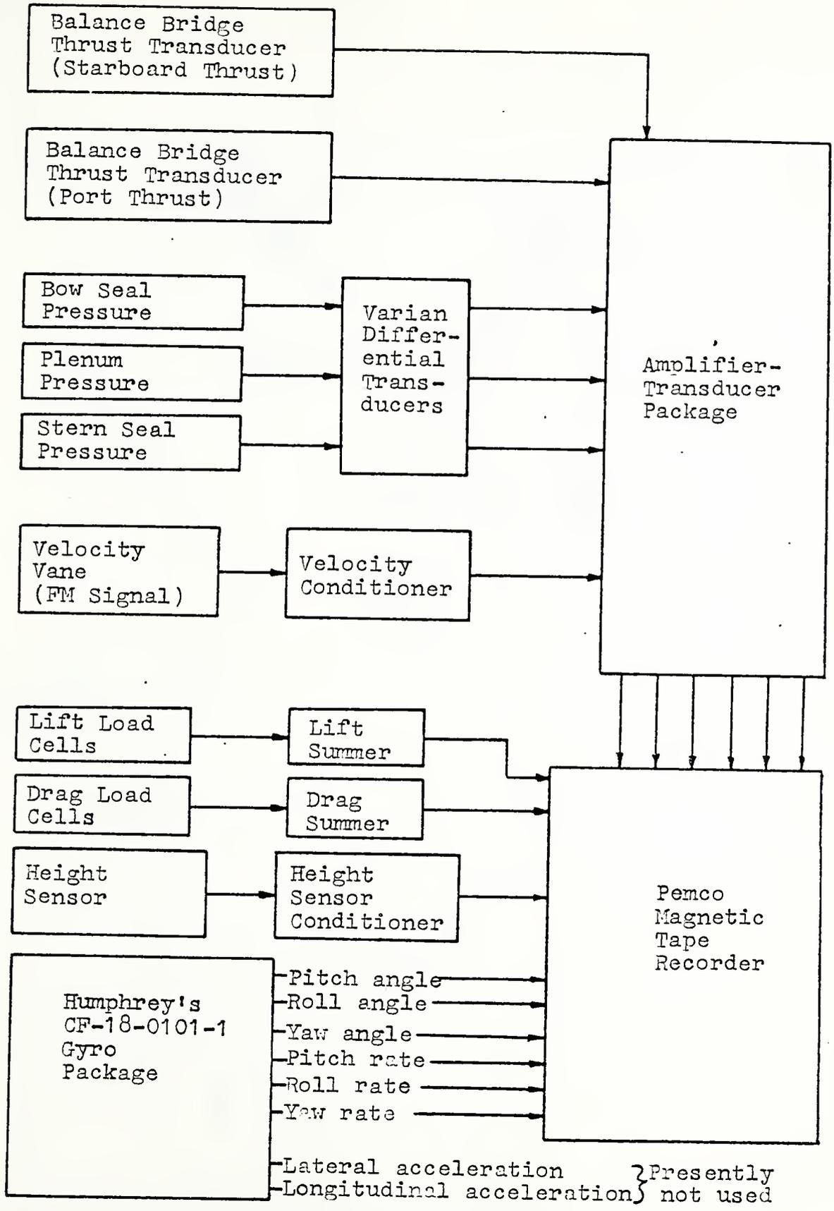
Figure 5. DATA ACQUISITION SYSTEM
